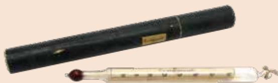
***Gluco-œnomètre ou pèse-moût utilisé pour la fabrication du vin.***
